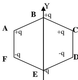
corresponden a los vértices de un hexágono regular de 5cm de lado, están situadas las cargas que se indican ( $q = 1nC$ ). Hallar el valor del campo eléctrico en el origen de coordenadas, que coincide con el centro del hexágono.
